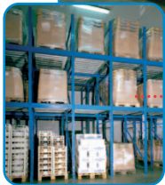
Scaffalature a gravità a rulli assicurano rotazione del prodotto con risparmio di spazio e tempo nella movimentazione dei palleti
